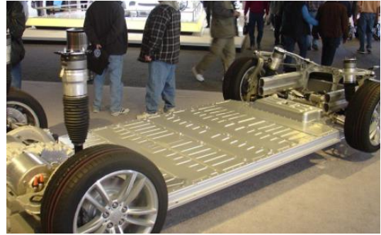
Рисунок 12 – Представлены усовершенствованные, тяговые ЛИБ
